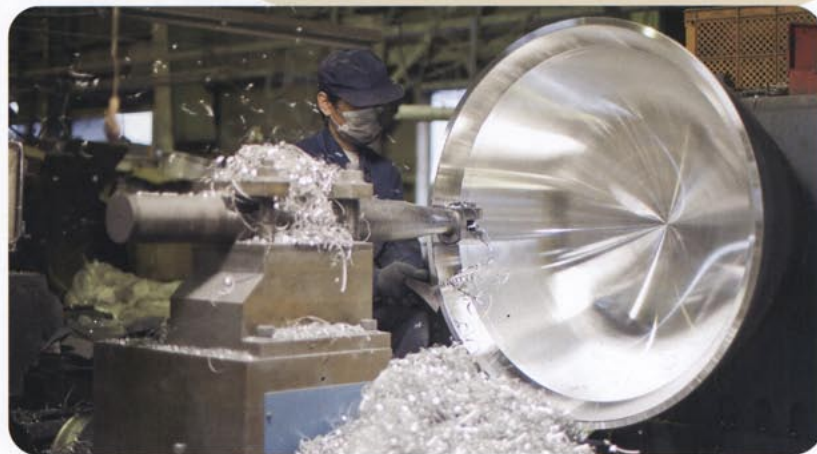
大きな鍋は、大型NC旋盤機でスピーディに切削していく。この後、さらに職人の手により表面を滑らかにする作業を行なう。
