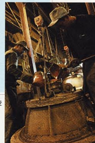
金型に溶けたアルミを流し込んで铸造する
