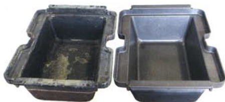
フッ素樹脂がはがれた釜(左)も、再コーティングにより、新品同様になる(右)。業界に先んじて始めたサービスだ
