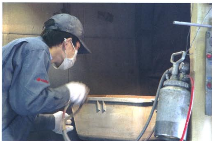
回転台の上に乗せてフッ素樹脂をコーティングするため、均一な塗膜を作ることができる
